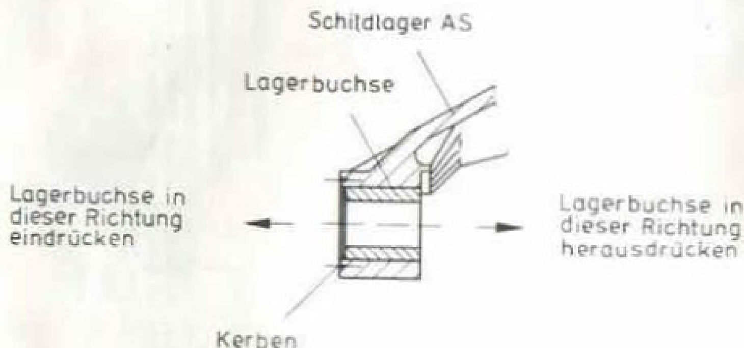
Abb. 3: Aus- und Einbau der Lagerbuchse
