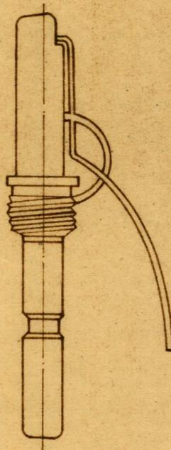
Der Zünder DS-62 wird verwendet zur Komplettierung der Handgranate F 1 und zur Zündung der Sprengladung derselben.
